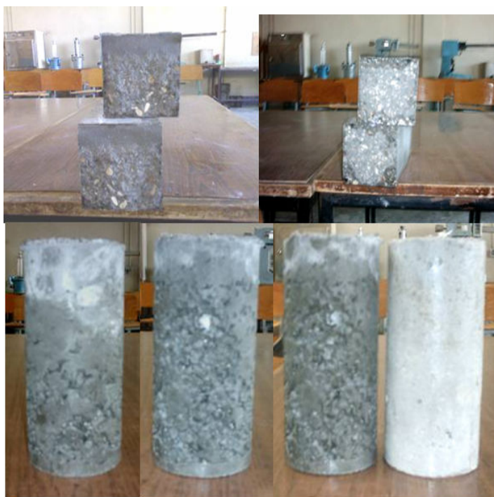
شکل ۳-۲ نمایش طرح‌های دارای جداشدگی و طرح‌های مناسب
