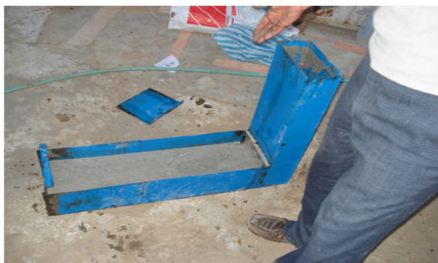
شکل ۳-۸ نحوه اجرای آزمایش جعبه ال-شکل و اندازه گیر T ۲۰ , T ۴۰ ارتفاع پرکنندگی
