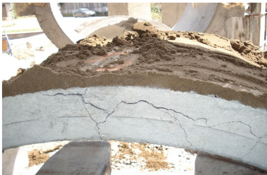
شکل ۳-۲۳ نمای ترک حاصل از بارگذاری
