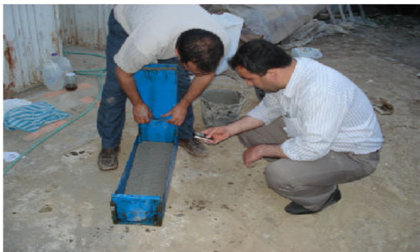
شکل ۳-۷ نحوه اجرای آزمایش جعبه ال-شکل و اندازه گیری زمان رسیدن به فواصل ۲۰ و ۴۰ سانتیمتری
