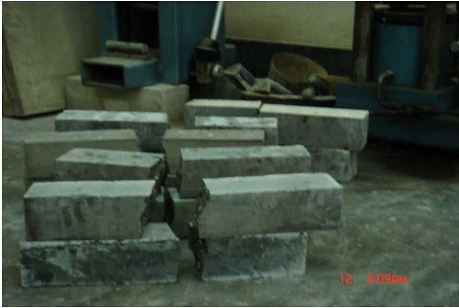
شکل ۳-۱۳: نمونه‌های شکسته شده در یک سوم میانی
