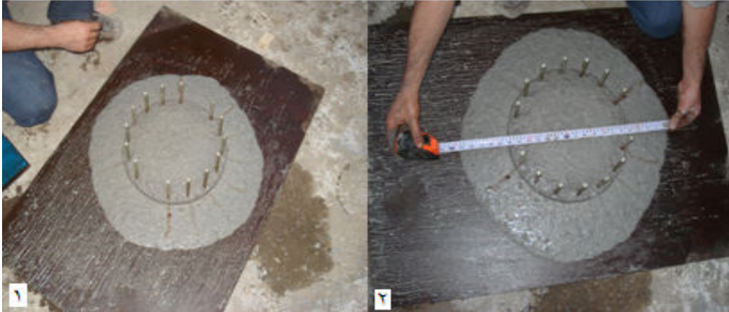
شکل ۳-۵ نحوه اجرای آزمایش حلقه جی-شکل در کارگاه بابلسر
