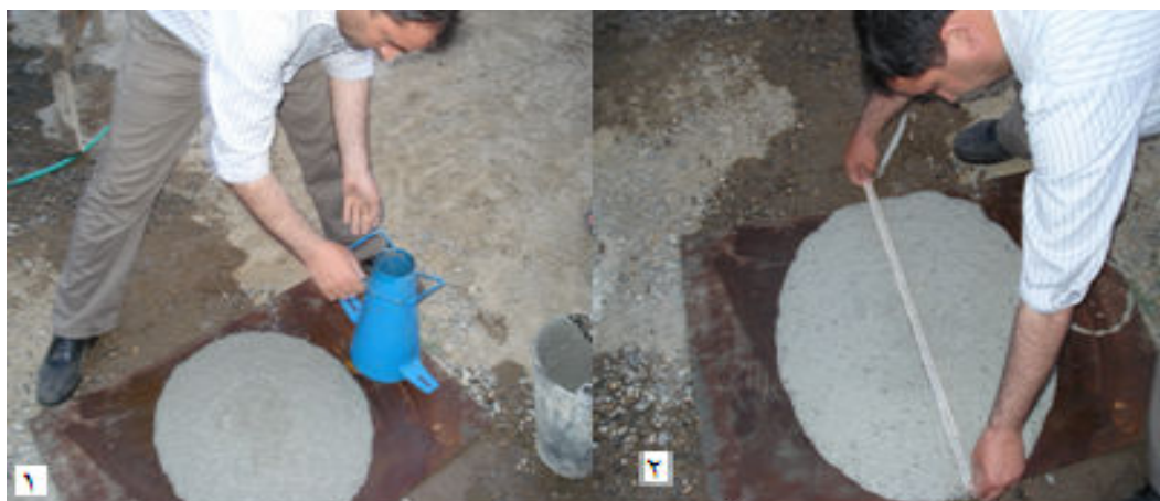
شکل ۳-۴ نحوه اجرای آزمایش جریان اسلامپ و محاسبه قطر نهایی
