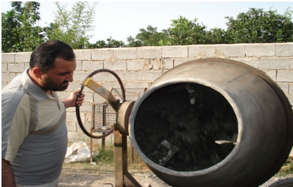
شکل ۳-۲۴ آماده سازی بتن خودتراکم در آزمایشگاه
