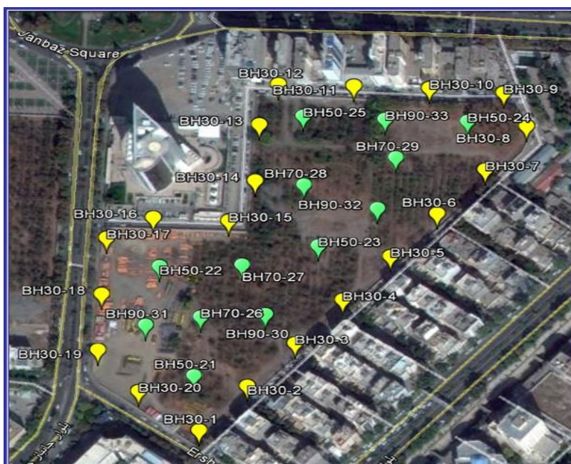
شکل ۳-۲- موقعیت گمانه های حفاری شده در پروژه
