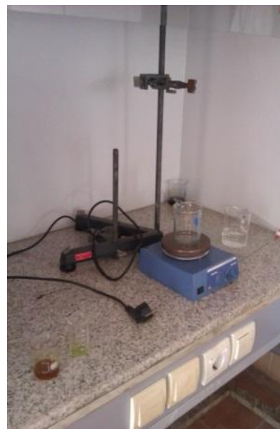
شکل ۳-۳ قرار دادن محلول نمک‌ها روی همزن مغناطیسی
