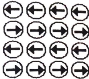
شکل ۲-۶ جهت‌گیری دو قطبی‌های مغناطیسی در مواد پاد فرومغناطیس [۶۴].
