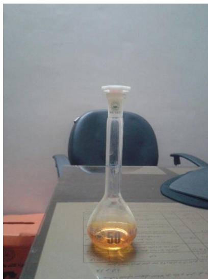
شکل ۳-۵. پیکنومتر مورد استفاده برای آزمایش تعیین Gs
