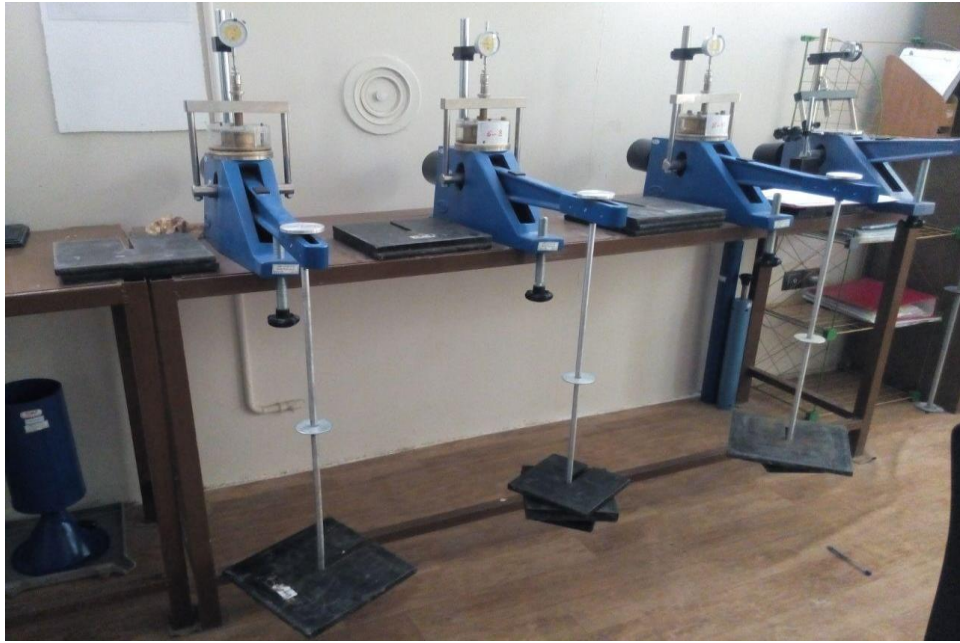
شکل ۳-۷. دستگاه تحکیم مورد استفاده در آزمایش تحکیم یک بعدی
