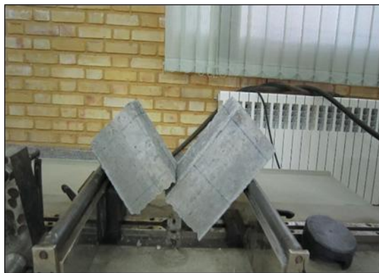
شکل ۳-۷ شکل هندسی دستگاه آزمون مقاومت خمشی بتن - روش بارگذاری چهار نقطه‌ای
