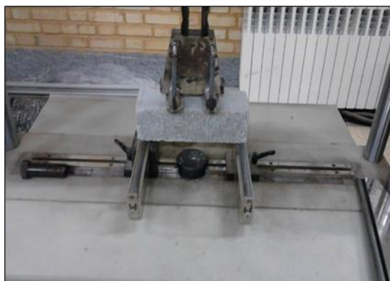
شکل ۳-۸ آزمایش مقاومت خمشی تیر بتنی قبل و بعد از شکست نمونه
