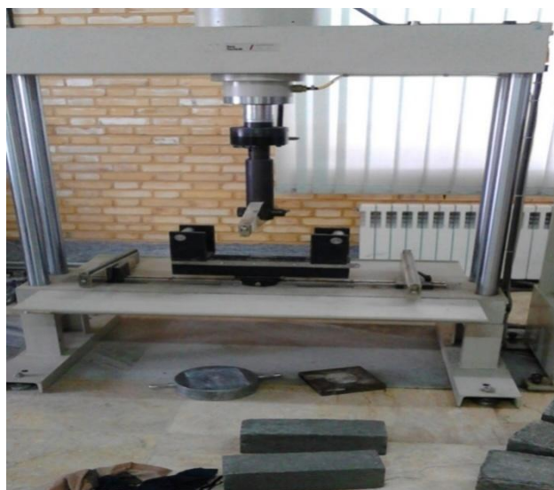
شکل ۳-۹ دستگاه جک هیدرولیکی استفاده شده برای آزمایش مقاومت خمشی
