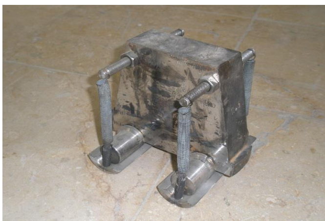
شکل ۳-۹ دستگاه جک هیدرولیکی استفاده شده برای آزمایش مقاومت خمشی
