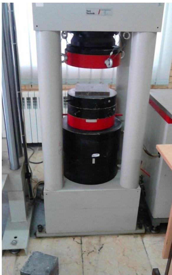
شکل ۳-۵ جک هیدرولیکی استفاده شده برای آزمایش مقاومت فشاری
