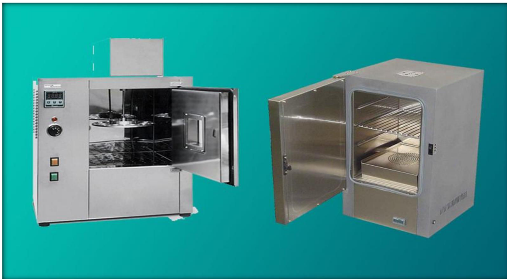
شکل (۳-۱۱) دستگاه تعیین افت وزنی قیر مطابق با استاندارد ASTM D 06
