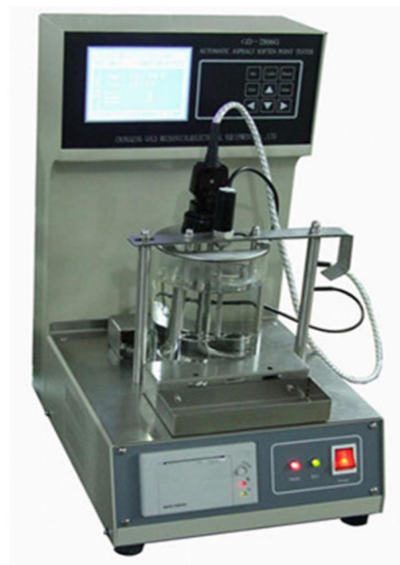
شکل (۳-۱۰) دستگاه اندازه‌گیری نقطه نرمی مطابق با استاندارد ASTM D36
