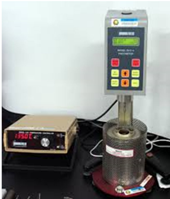
شکل (۳-۱۲) دستگاه تعیین ویسکوزیته قیر مطابق با استاندارد ASTM D4402
