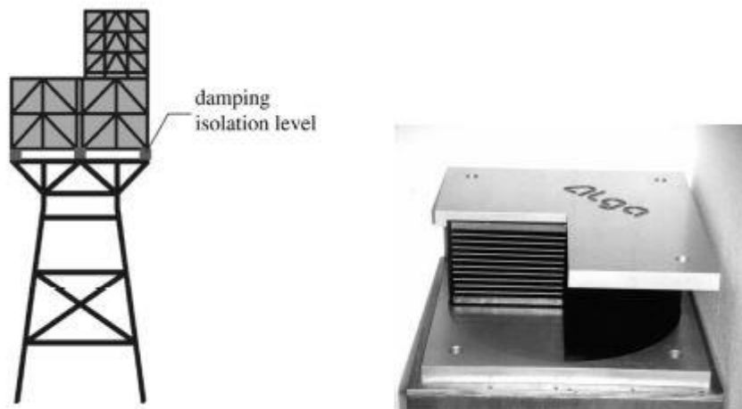
شکل (۲-۱). سیستم جداکننده و یک نمونه استفاده از آن در سکوی شابلونی [۷]
