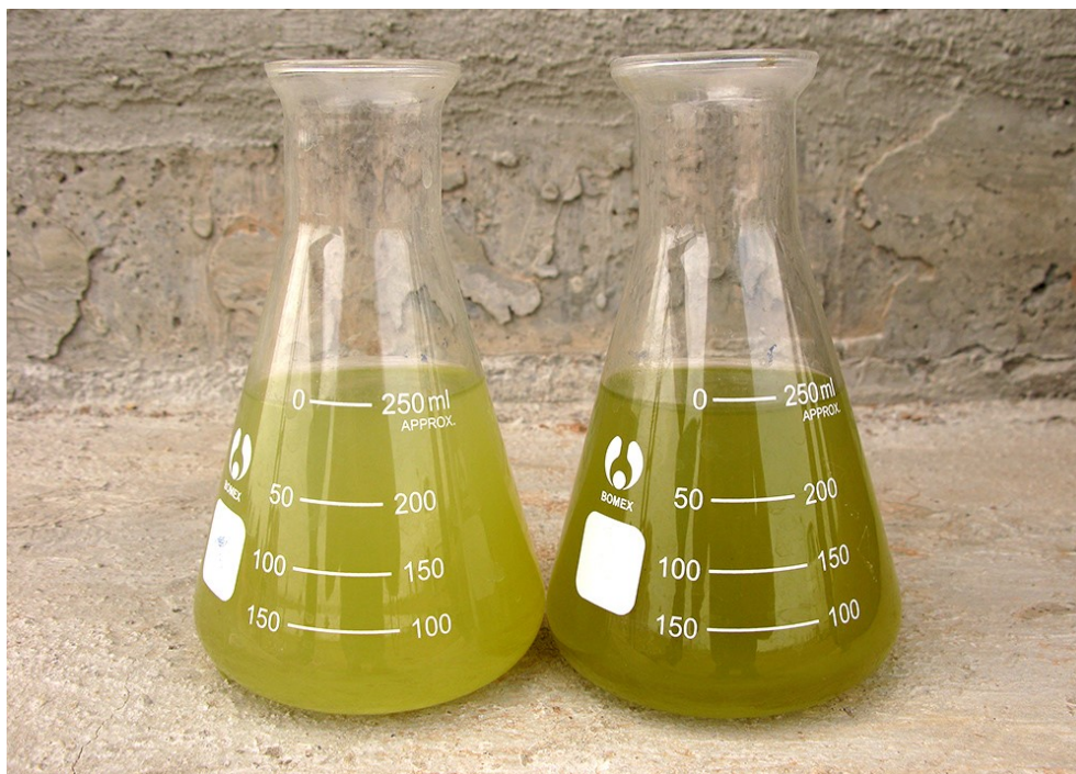
شکل ۴-۲: خروجی تصفیه‌خانه (سمت راست) در مقایسه با خروجی صافی B (سمت چپ)
