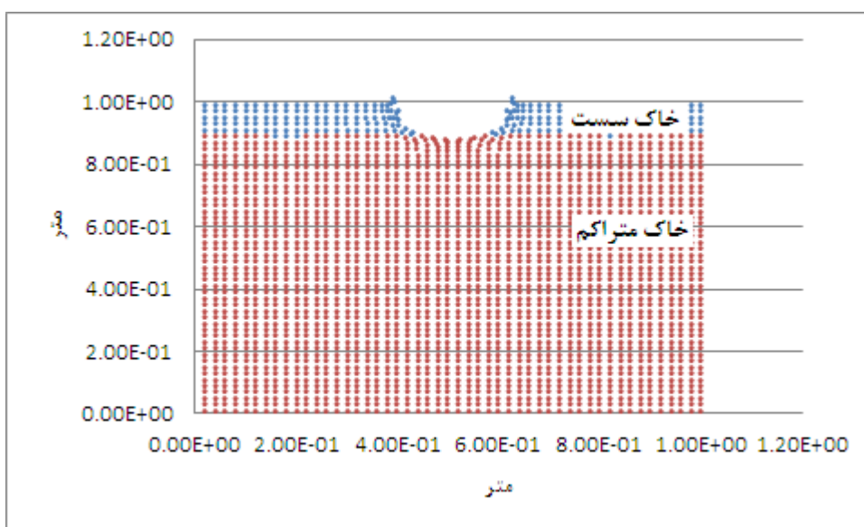
شکل ۵-۴۴- شکل گیری چاله انفجار در خاک دو لایه در زمان ۱۰۰ میکروثانیه
