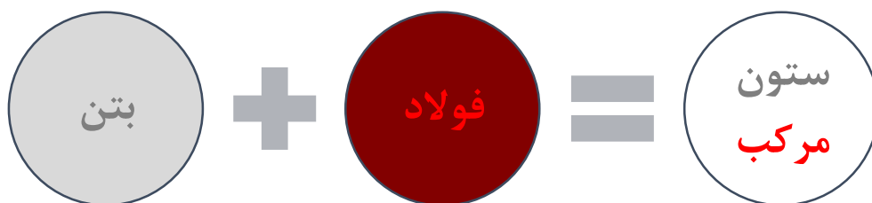
شکل (۱-۲): اجزای ستون مرکب در حالت کلی
