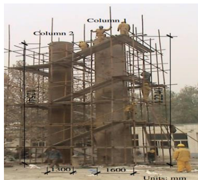
شکل (۳-۲): ستون‌های CFST بزرگ مقیاس آزمایش شده توسط Han- [۳]
