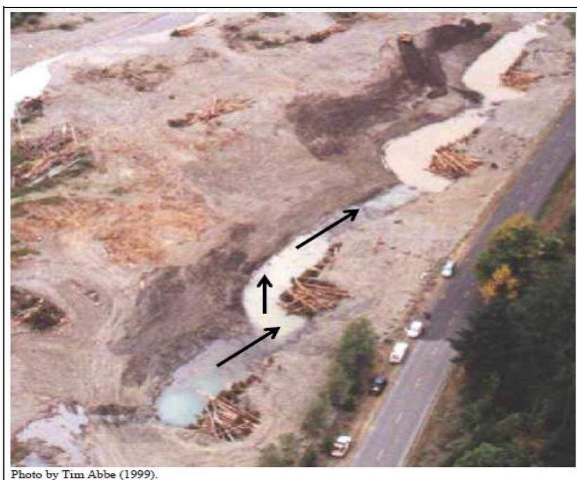
شکل ۲-۱۷: نمونه ای از ELJ های محافظت کننده دیواره ها و سواحل در طول رودخانه Cispus.
