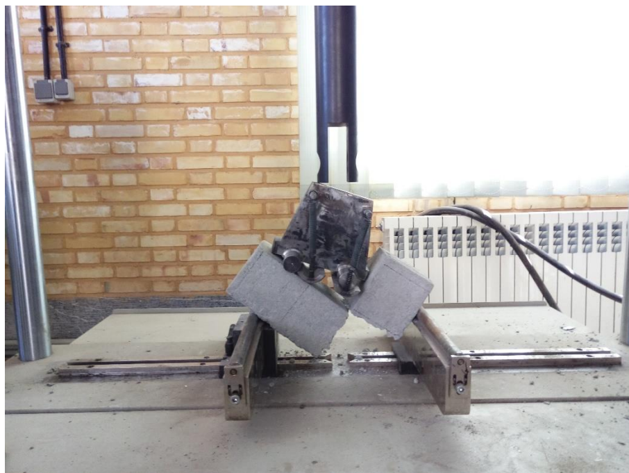
شکل ۴-۲۷- گسیختگی نمونه فوم بتن زیر دستگاه مقاومت خمشی
