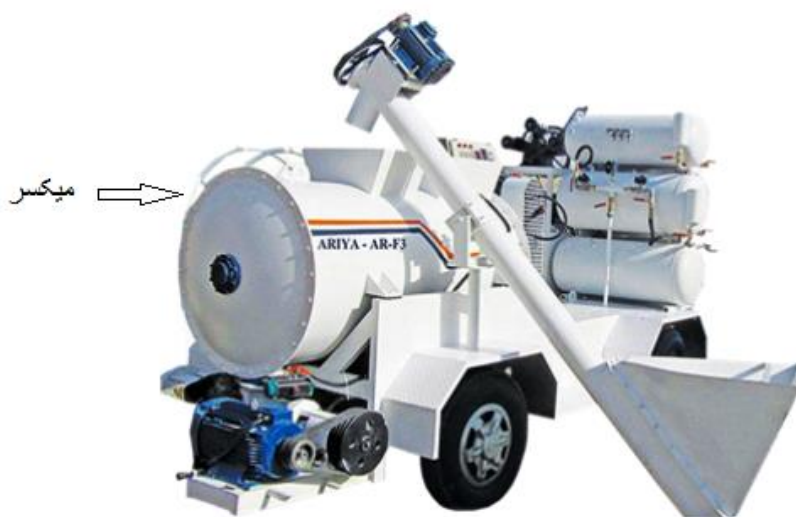
شکل ۳-۳- محل میکسر در سیستم فوم بتن ساز
