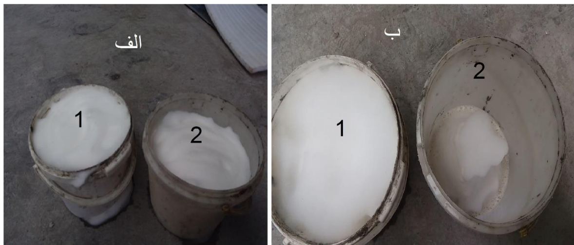
شکل ۳-۱۳-تاثیر مخرب روغن موتور بر کف فوم- الف: ظرف ۱، دیواره خشک و ظرف ۲، دیواره‌ی چرب شده، هر دو پر شده توسط کف فوم. ب: ظروف ۱ و ۲ پس از گذشت ۵ دقیقه.
