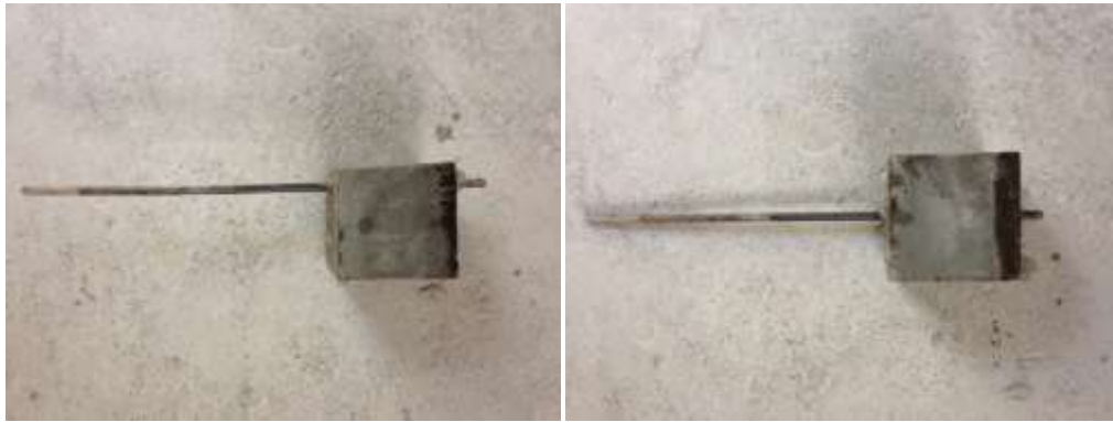
شکل ۳-۶ نمونه های ساخته شده جهت انجام آزمایش بیرون کشیدگی
