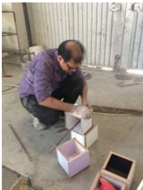
شکل ۴-۷ قالب گیری نمونه های ساخته شده براساس استاندارد RILEM
