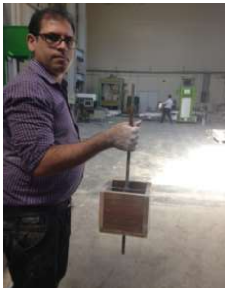
شکل ۴-۶ قالب گیری نمونه های ساخته شده براساس استاندارد RILEM
