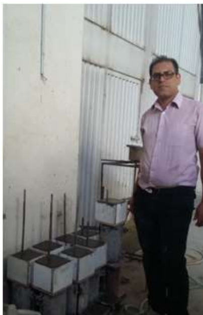
شکل ۴-۷ قالب گیری نمونه های ساخته شده براساس استاندارد RILEM
