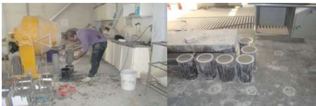
شکل ۳-۴ نمونه گیری از بتن فوق توانمند با نمونه استاندارد استوانه ای
