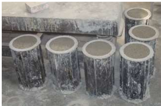
شکل ۴-۹ نمونه برداری استوانه ای استاندارد
