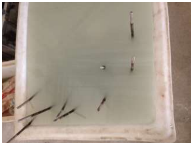
شکل ۴-۱۰ عمل آوری نمونه ها درون آب ۲۰ درجه سانتی گراد
