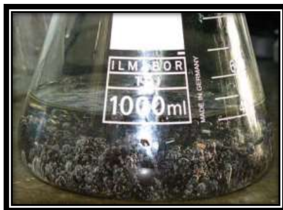
شکل ۳-۷- نمونه متراکم نشده داخل ارلن
