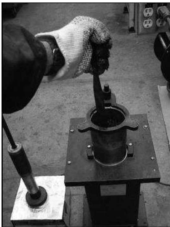
شکل ۳-۵- ریختن مصالح آغشته به قیر در قالب (۲۲)
