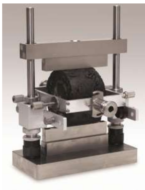
شکل ۳-۱۱- اندازه‌گیری مقاومت کششی غیرمستقیم نمونه (۹)
