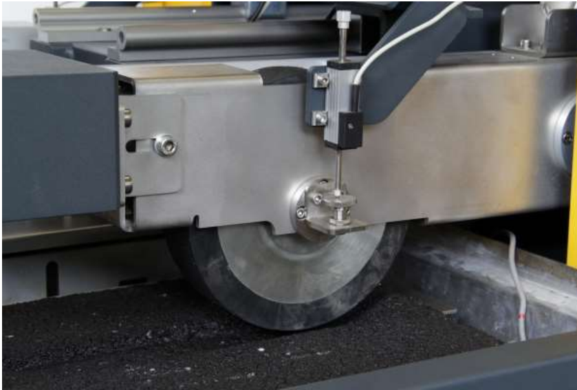
شکل ۱-۲- دستگاه آزمایش مسیر چرخ هامبورگ (HWTT) (۷)
