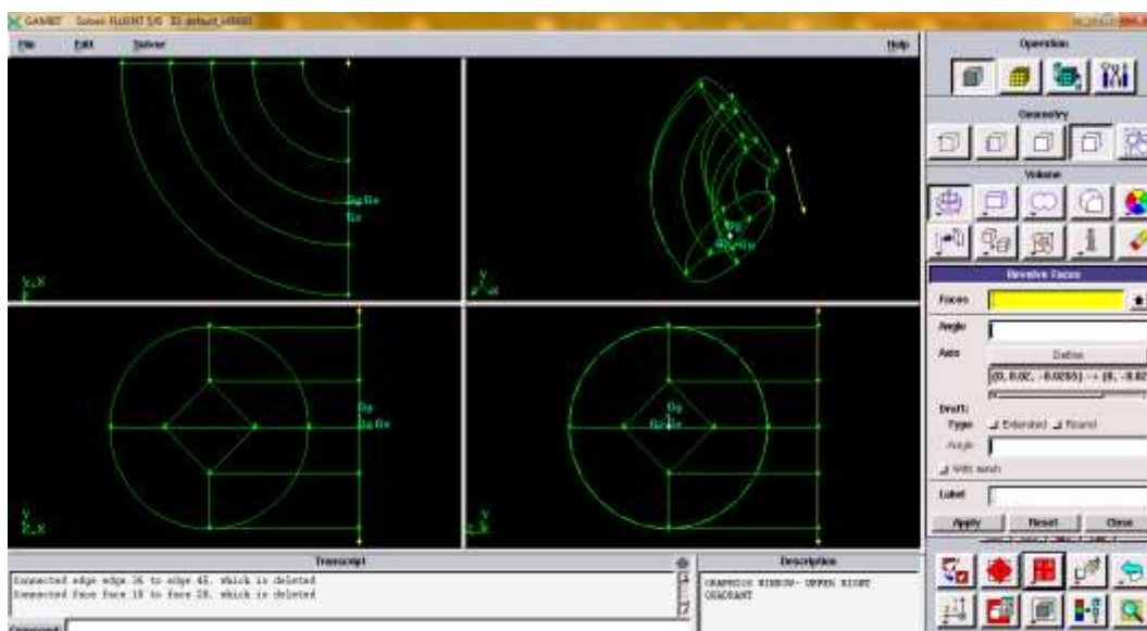
شکل ۳-۵ ایجاد زانویی با استفاده از دستور revolve faces
