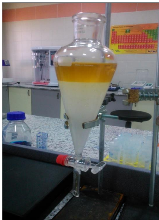
شکل ۳-۱: مخلوط آب و گازوئیل در قیف جداکننده
