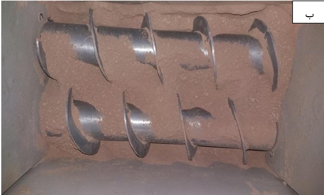
شکل ۳-۳: همزن مکانیکی طراحی شده در این تحقیق (الف: تصویر همزن، ب: تصویر پره‌های همزن)
