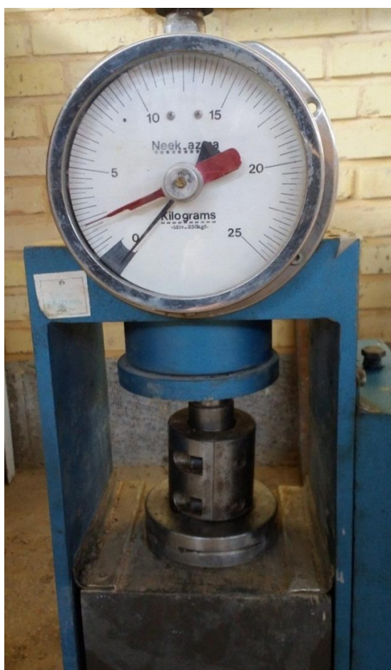
شکل ۳-۵: پرس هیدرولیکی مواد آجر تحت فشار ۱۵ مگاپاسکال
