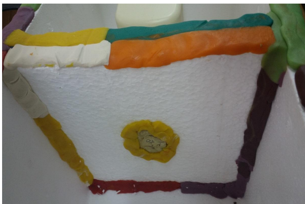
شکل ۳-۱۰: جعبه‌ی آکوستیک عایق صوت از جهات مختلف
