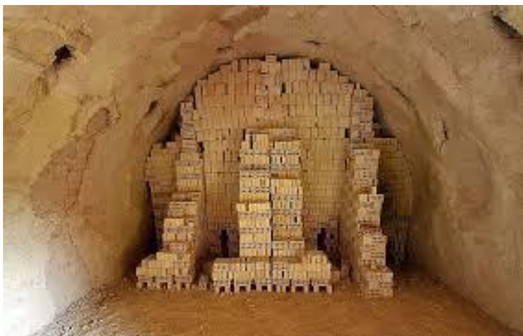
شکل ۲-۲: آجر چیده شده در کوره هوفمان
