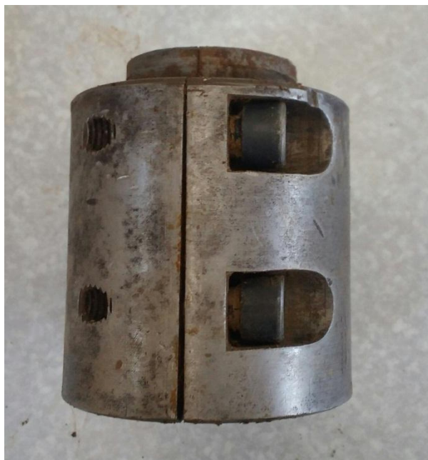
شکل ۳-۴: قالب آجر ساخته شده در این تحقیق
