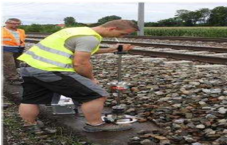
شکل ۲-۲۲ LFWD در لایه بستر خط در اتریش استفاده می‌شود
