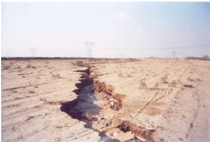
شکل (۱۱-۳) ترک های ایجاد شده در پوسته زمین بر اثر فرونشست ایستگاه گرداب
