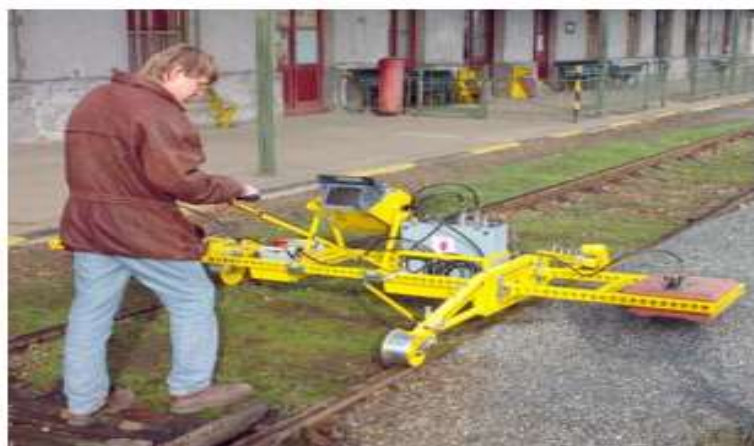
شکل ۲-۲۵ دستگاه GPR مجهز به سیستم های آنتن بر روی درزین ریلی CRAB
