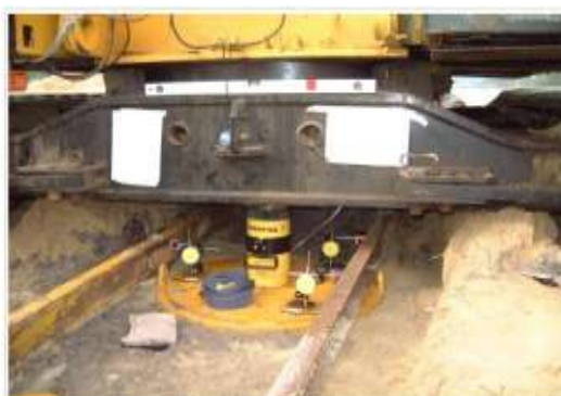
شکل (۲-۵۰) آزمون بارگذاری صفحه با استفاده از جرثقیل زنجیری بعنوان عکس العمل برای آزمون‌های تا ۵۰
