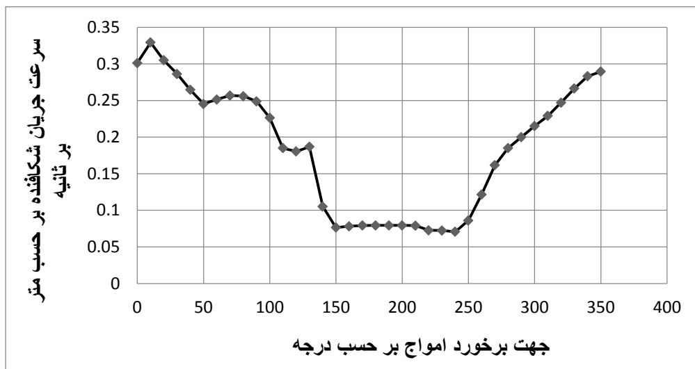
شکل ۴-۱۷- رابطه بین جهت برخوردی موج و سرعت جریان شکافنده در زاویه صفر درجه.
