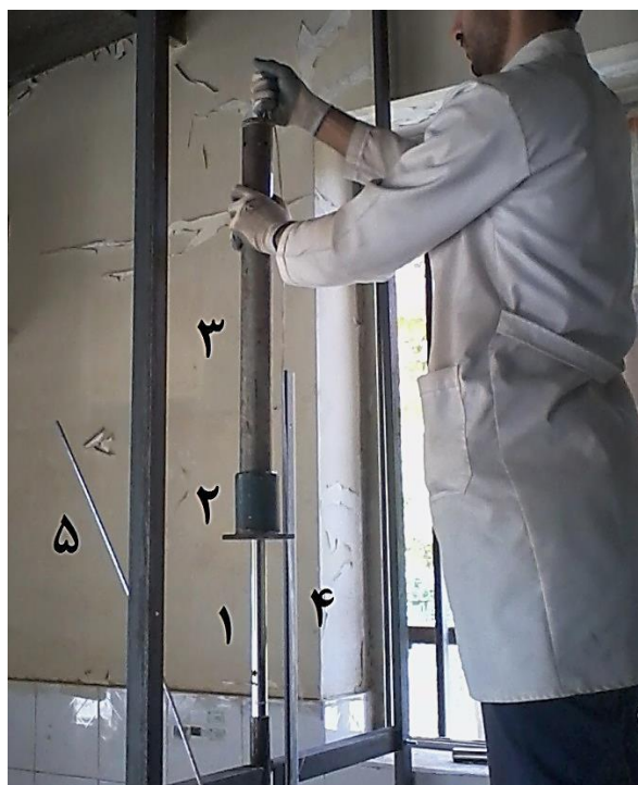
شکل ۳-۸ عملیات کوبش مدل شمع ۱- مدل شمع ۲- کلاهک فولادی ۳- چکش کوبش ۴- خطکش اندازه‌گیری مقدار نفوذ شمع در حین عملیات کوبش ۵- خطکش اندازه‌گیری مقدار نفوذ خاک برای شمع ته باز
