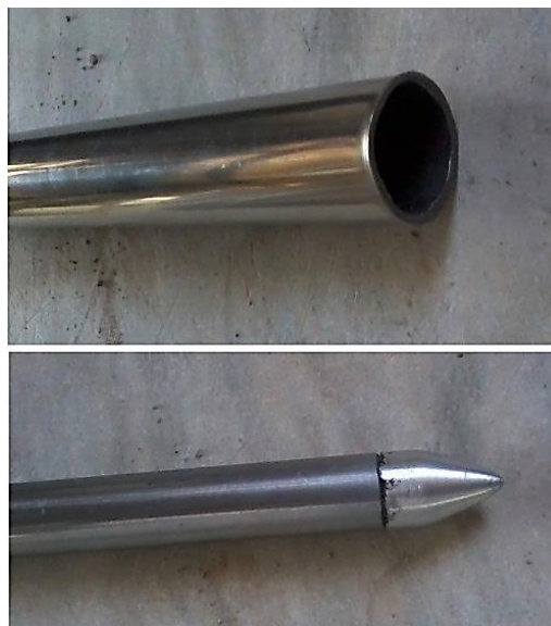
شکل ۳-۶ مدل شمع ته باز و ته بسته
