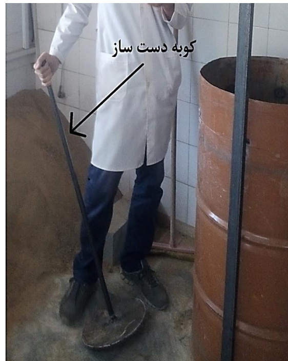
شکل ۳-۲ کوبه دست ساز جهت تراکم نمونه خاک
