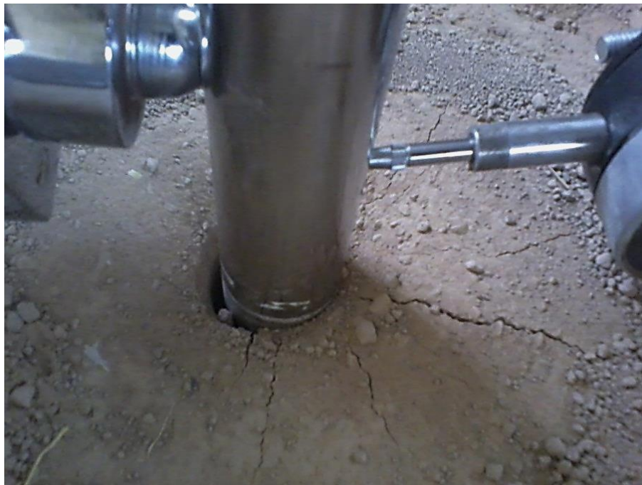
شکل ۳-۱۲ بارگذاری جانبی مدل شمع و گسیختگی خاک
