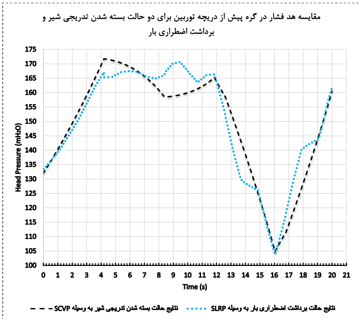
شکل ۴-۲۶ نمودار مقایسه‌ی هد فشار در گره پیش از دریچه‌ی توربین در حالت بسته شدن تدریجی شیر و برداشت اضطراری بار
