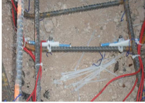
شکل ۲-۱۸ نصب کرنش سنج به شبکه آرماتورها (Jaiswal, et al., 2012)
