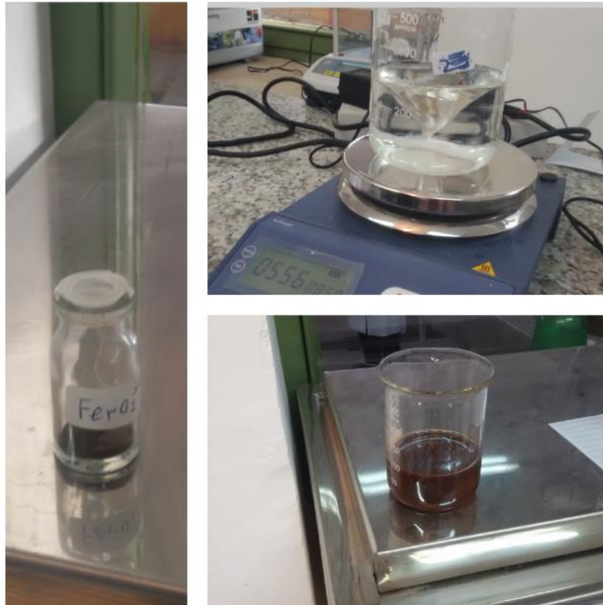
شکل ۳-۷ نانو آهن Fe_3O_4 و محلول PAA هنگام ترکیب با آب و تثبیت آن
