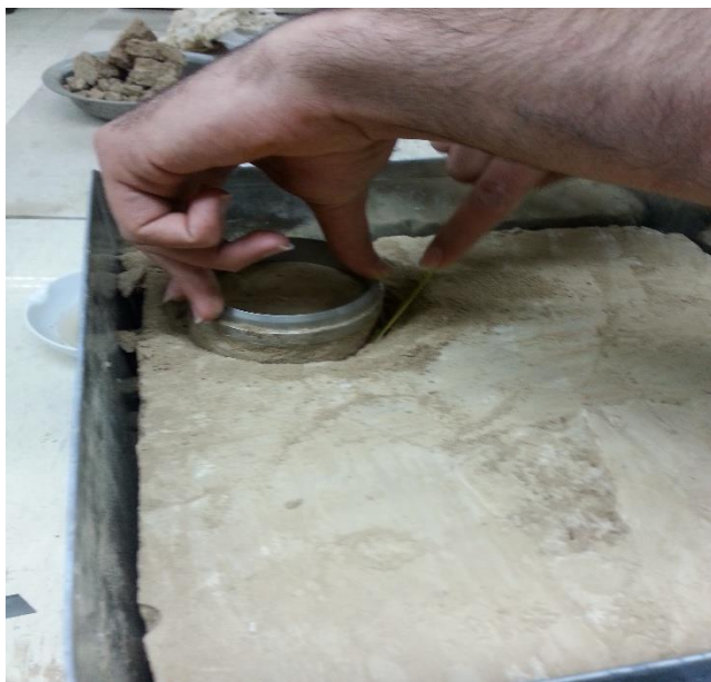
شکل ۳-۵ نحوه برداشت نمونه آزمایشگاهی
