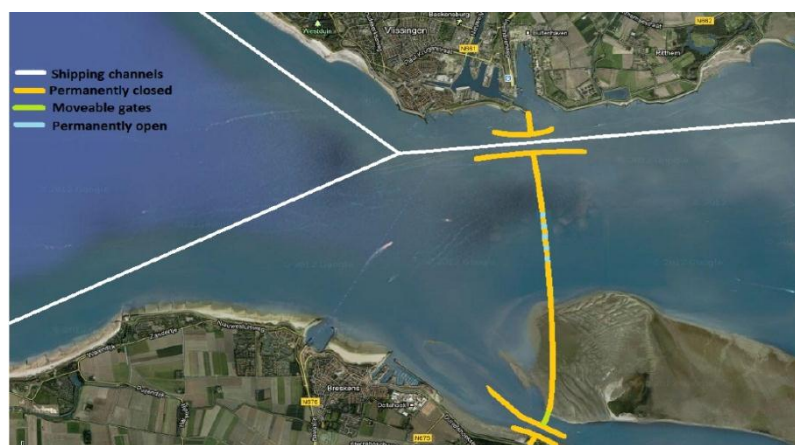
شکل (۷-۲) جانمایی سازه دیواره منقطع کاهنده
