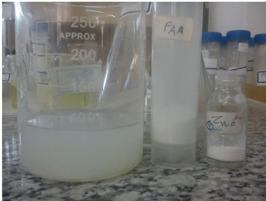
شکل ۳-۳- محلول نانو تثبیت شده با PAA
