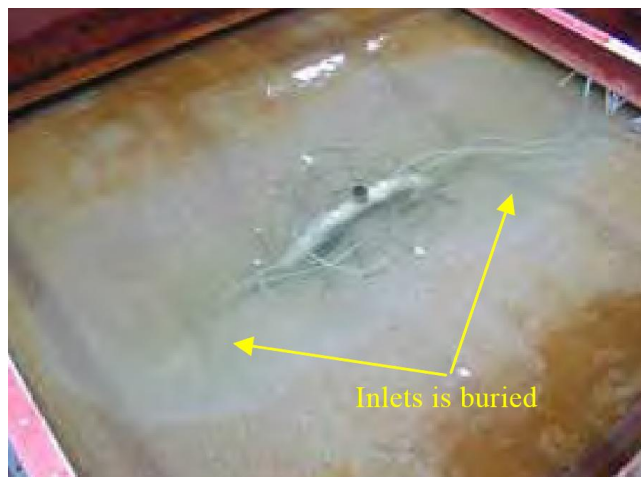
شکل ۲-۱۰: آبگیرهای مدفون در حالت دو آبگیر (Sakurai, et al., 2007)
