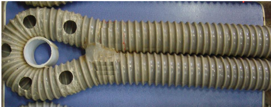
شکل ۳-۶: آرایش حفره‌ها در قسمت خم لوله
