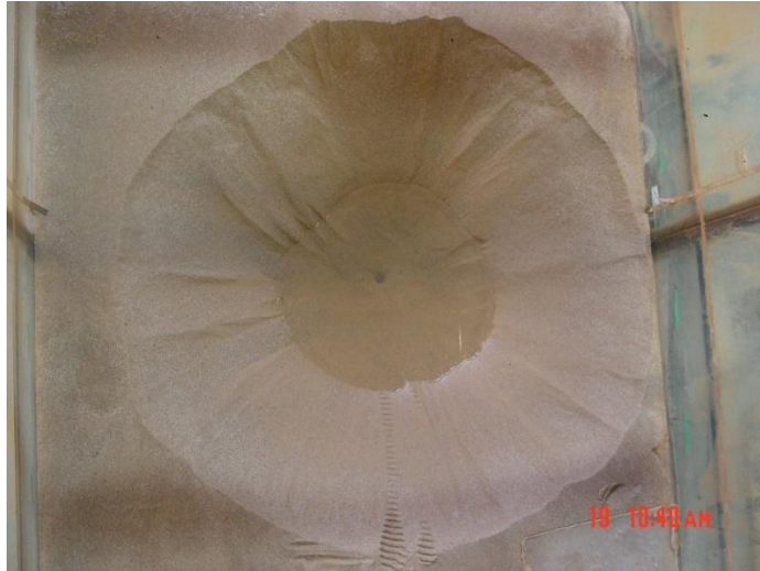
شکل ۴-۴: شکل مخروط آبشویی در مخزن
