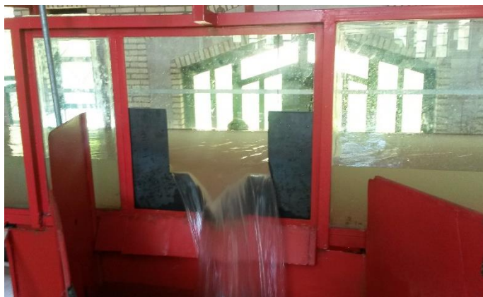
شکل (۳-۲۸) جریان عبوری از سرریزهای مرکب مثلثی - مستطیلی در فلوم B
