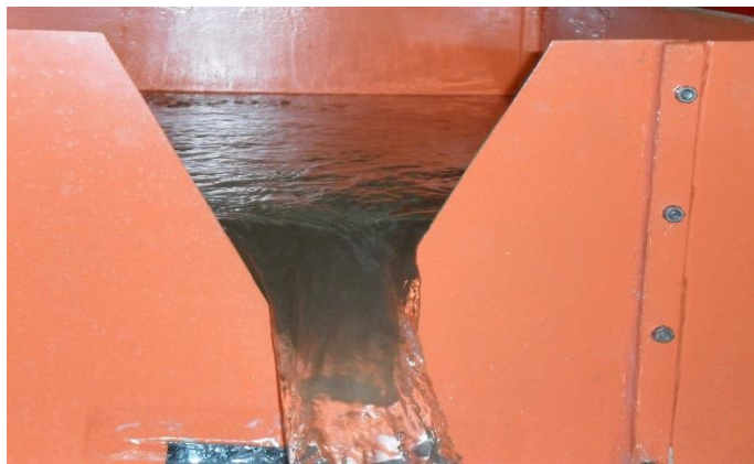
شکل (۳-۲۷) جریان عبوری از سرریزهای مرکب مستطیلی - مستطیلی در فلوم A
