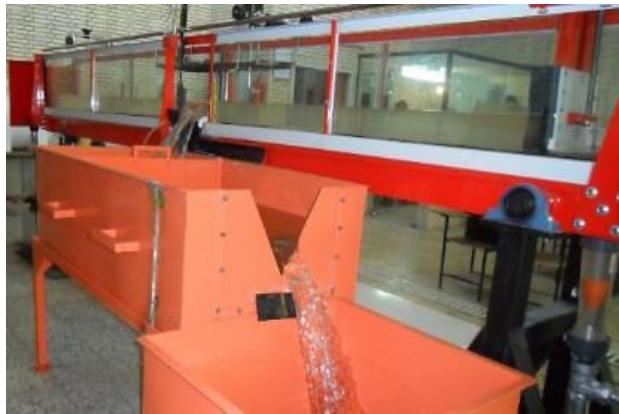
شکل (۳-۲۰) فلوم آزمایشگاهی A، سرریز جانبی، سرریز مثلثی و عمق سنج
