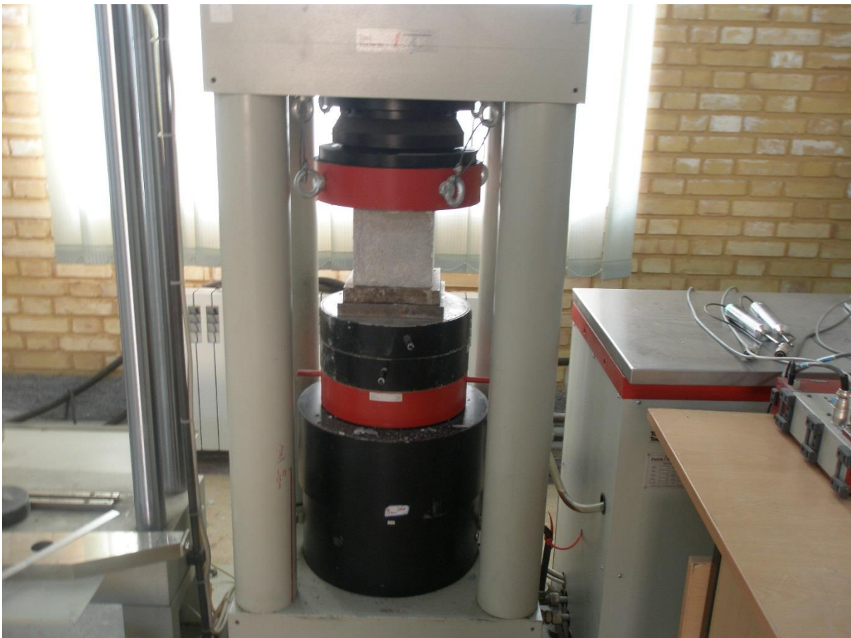
شکل ۳-۴: آزمایش مقاومت فشاری نمونه های مکعبی
