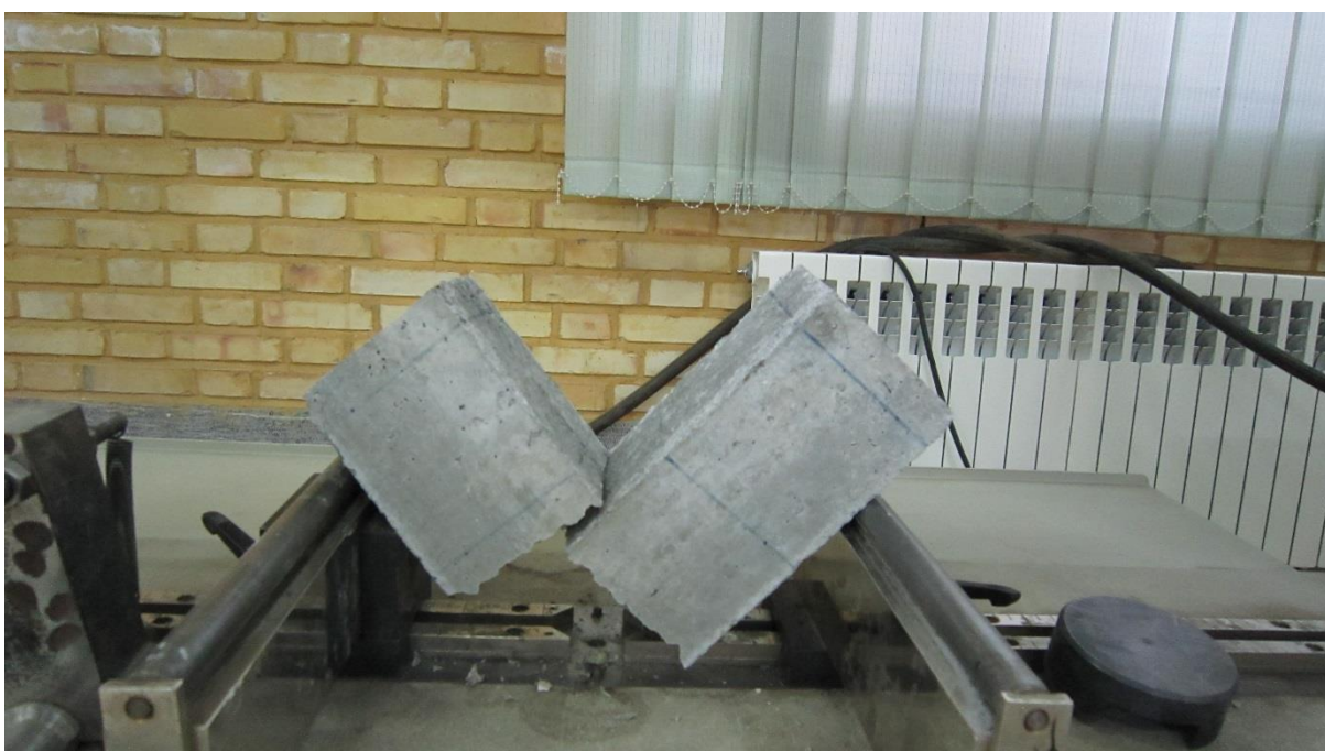
شکل ۴-۱۵: تیر بتنی بعد از شکست در آزمایش مقاومت خمشی
