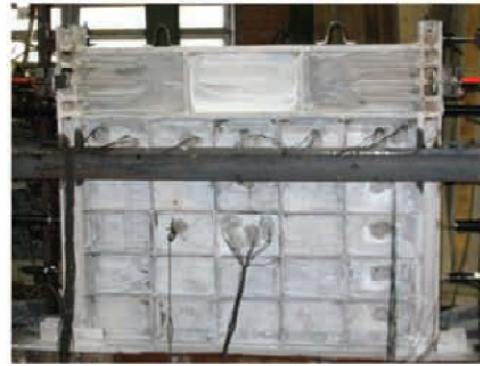
شکل (۳-۵) شمای نمونه دیوار برشی فولادی با سخت کننده- آزمایشگاه سازه مرکز تحقیقات ساختمان و مسکن
