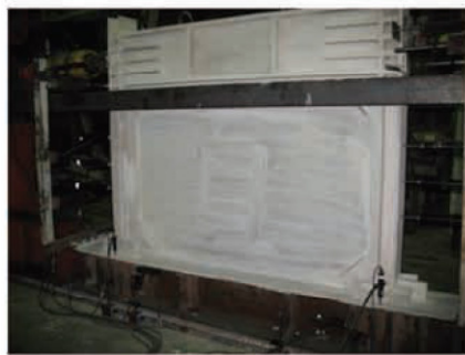
شکل (۳-۶) شمای نمونه دیوار برشی فولادی بدون سخت کننده- آزمایشگاه سازه مرکز تحقیقات ساختمان و مسکن
