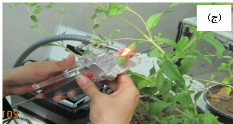
شکل ۲-۳ دستگاه فلورومتر (PAM-2500, Walz, Germany) (الف) و اندازه‌گیری فلورسانس کلروفیل a در برگ‌های گیاه استویا (ب) و (ج). جدول ۳-۳- مؤلفه‌های بیوفیزیکی اندازه‌گیری شده فلورسانس کلروفیل (اسکرپیر و همکاران، ۱۹۹۶، جنتی و همکاران، ۱۹۸۹، کلاچی و همکاران، ۲۰۱۱ و کلگرامر و اسکرپیر، ۲۰۰۸).
