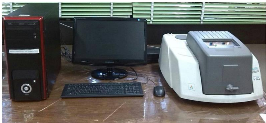
شکل ۳-۳: دستگاه طیف سنجی مادون قرمز، FT-IR
