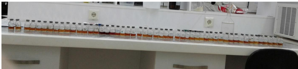
شکل 3-3: فراكشن های جمع آوری شده و کنترل شده توسط روش فنول-اسید سولفوریک
