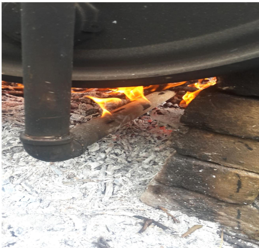
عکس ۳-۵- خروج گاز از سوراخ‌های تعبیه شده در لوله و استفاده به عنوان سوخت مکمل
