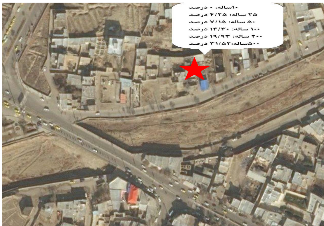
شکل (۴-۲۹) : برآورد درصد خسارت وارد شده ساختمان مسکونی
