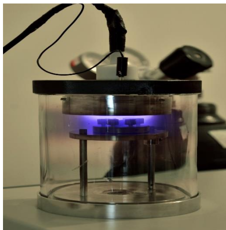
شکل ۳-۱: تصویر میکروسکوپ الکترونی روبشی (سمت راست) و دستگاه پوشش دهنده طلا روی نمونه (سمت چپ)
