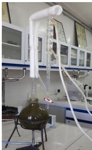
شکل ۳-۳. دستگاه کلونجر (اصلی)
