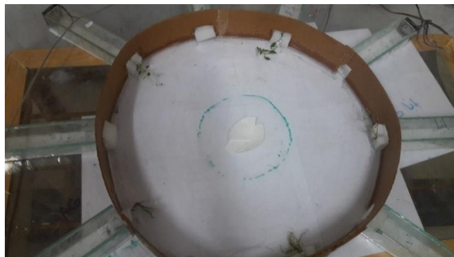
شکل ۳-۶. دستگاه بویایی سنج حاوی برگ ارقام مختلف سیب زمینی (اصلی)
