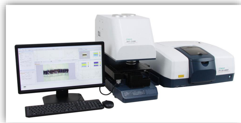
شکل ۳-۱: دستگاه طیف سنجی مادون قرمز، FT-IR مدل ۴۳۰ (Jasco، ساخت ژاپن)
