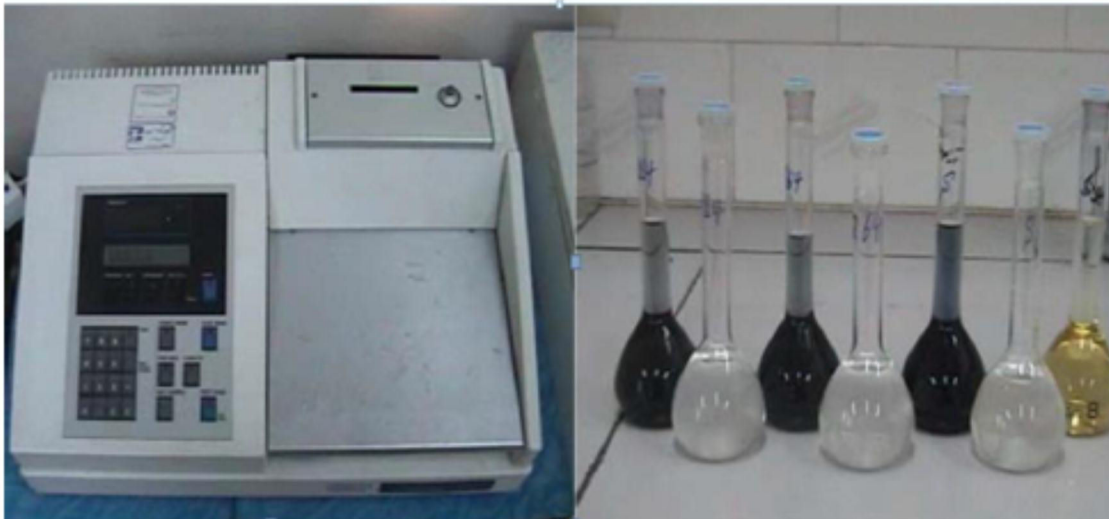
شکل ۳-۲- الف: آماده سازی نمونه برای آزمون آمیلوز ب: دستگاه اسپکتروفوتومتر برای اندازه‌گیری آمیلوز
