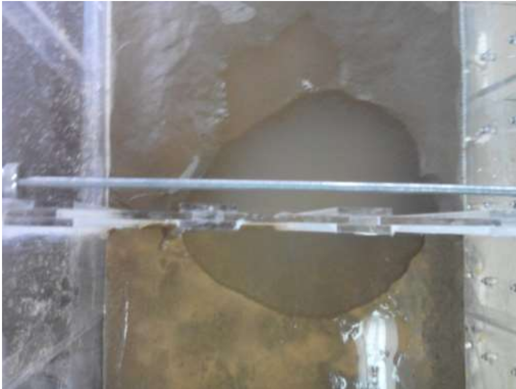
شکل ۲-۴ نمای بالا از تخریب پی بر اثر پدیده جوشش
