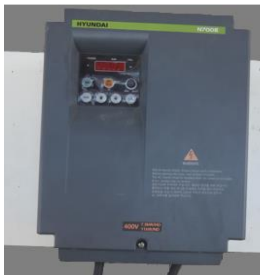
شکل ۳-۹- دستگاه اینورتور استفاده شده در این تحقیق برای ایجاد جریان غیرماندگار
