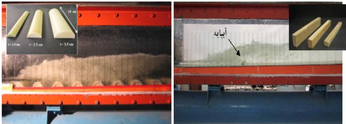
شکل ۲-۱۰ آبپایه و زبری‌های نیم استوانه‌ای شکل با ارتفاع ۱/۵، ۲/۵ و ۳/۵ سانتیمتر و نمونه‌ای از تشکیل پرش هیدرولیکی
