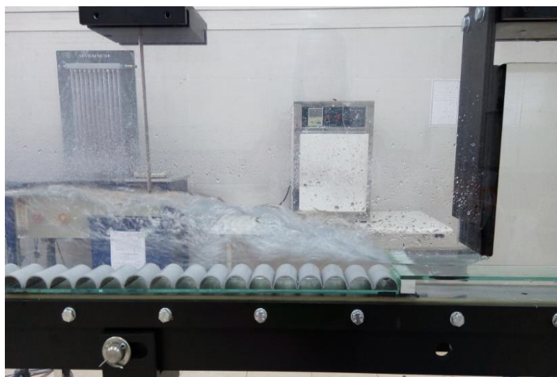
شکل ۳-۲۱ پرش هیدرولیکی در دبی 9/2 \text{ m}^3/\text{h} در شیب صفر برای زبری سوم بدون فاصله بین زبری
