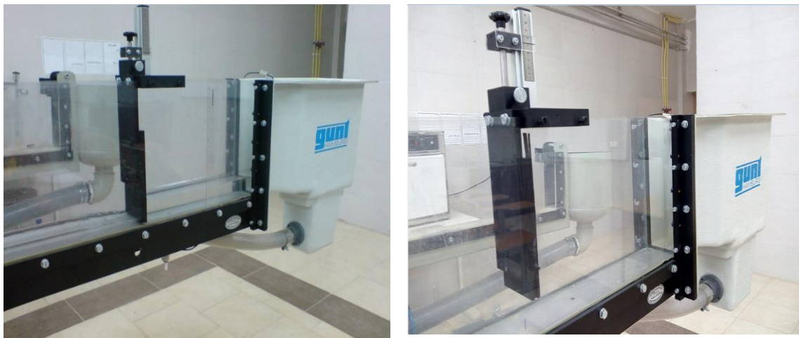
شکل ۳-۴ نمای ورود لوله انتقال آب به مخزن ابتدایی فلوم و دریچه کشویی
