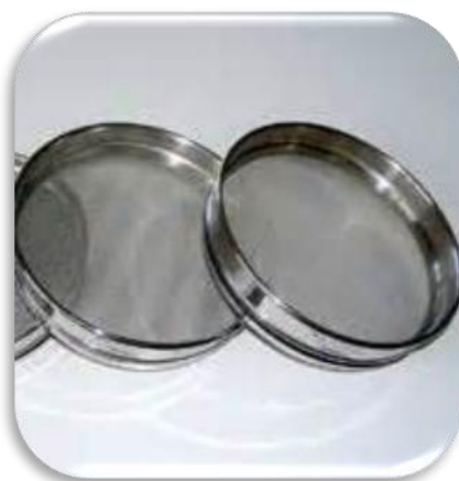
شکل (۳-۸) شمایی از فیلترهای فلزی ۲۵۰ میکرون
