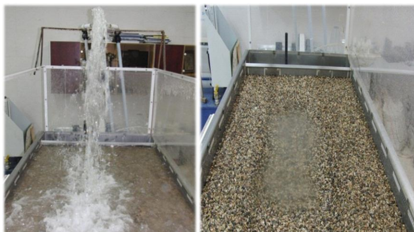
شکل ۴-۲۶- نمایی از جت‌های ریزشی آزاد با زاویه برخورد ۴۵ درجه و حفره ایجاد شده در پایین دست
