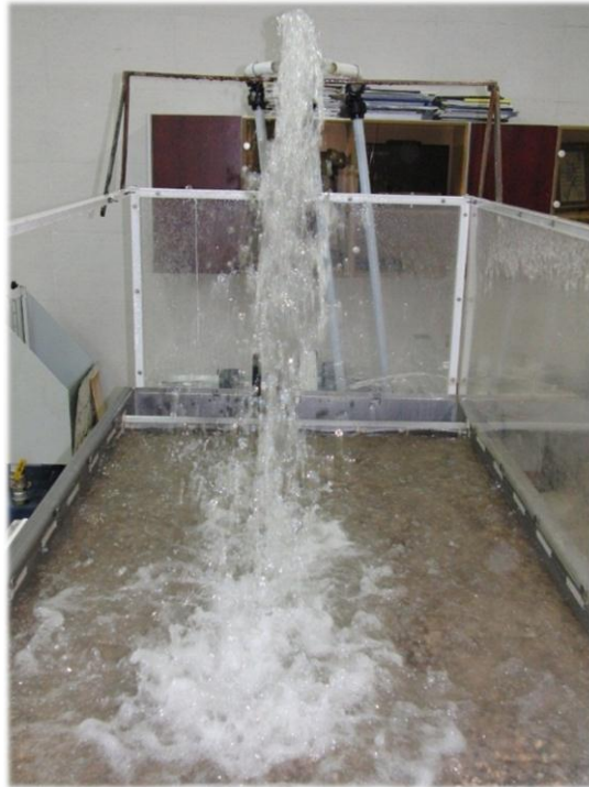
شکل ۳-۹- نمایی از فلوم آزمایشگاهی بعد از برداشتن پوشش پلی اتیلنی از روی بستر و شروع آزمایش
