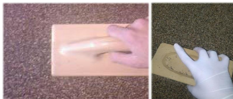
شکل ۳-۷- مسطح و متراکم کردن سطح بستر قبل از شروع هر آزمایش
