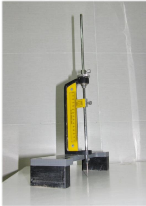
شکل ۳-۶- عمق سنج نقطه‌ای مورد استفاده برای برداشت پروفیل و حداکثر عمق آبشستگی
