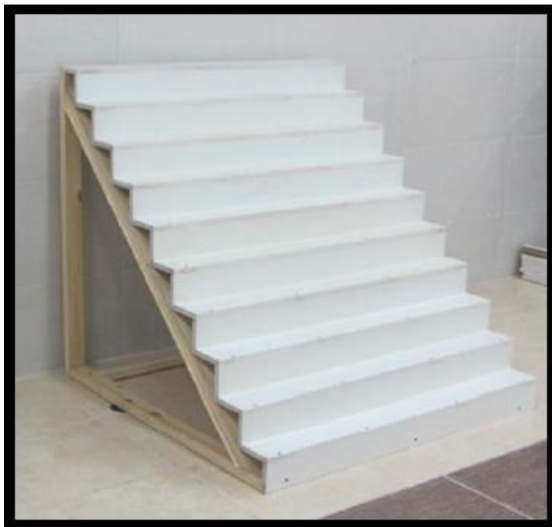
شکل ۲-۳- نمایی از سرریز پلکانی ( قبل از نصب)
