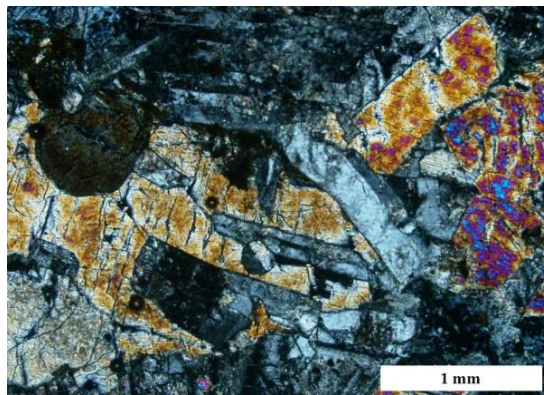
شکل ۳-۳۲- تصویری از بافت ساب‌افیتیک در سنگ‌های میکروگابرویی (نور XPL).
