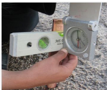
شکل ۴-۱۵- در این تصاویر نحوه برداشت شیب و جهت شیب، توسط کمپاس و تراز یاب مغزه نشان داده شده است.
