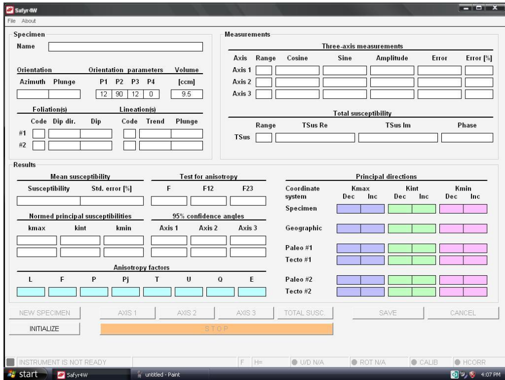
شکل ۱- مراحل مختلف اندازه‌گیری خودپذیری مغناطیسی با استفاده از نرم‌افزار Safyr4w.
