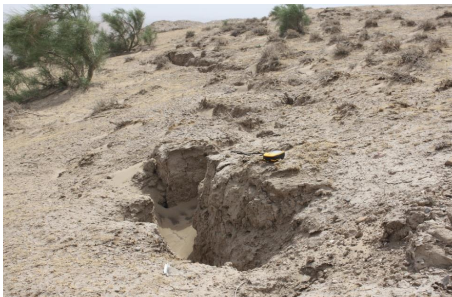
شکل ۵-۵: گسیختگی و افتادگی زمین در محدوده‌ی بین چاه‌های ۱۰ و ۳۱
