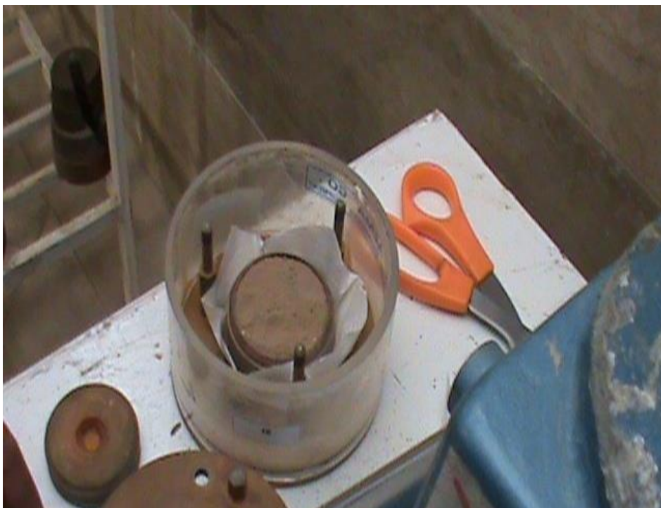
شکل ۵-۲۴: قرارگیری حلقه فلزی در ظرف مخصوص
