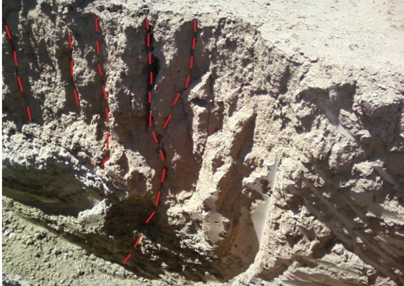
شکل ۵-۷: ادامه‌ی گسیختگی زمین در عمق
