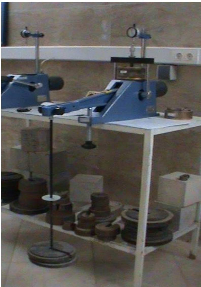
شکل ۵-۲۵: اندازه‌گیری میزان فشردگی در دستگاه ادنومتر
