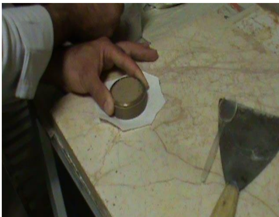
شکل ۵-۲۳: قرار دادن نمونه در حلقه فلزی
