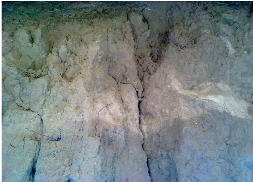
شکل ۵-۸: امتداد گسیختگی زمین در عمق
