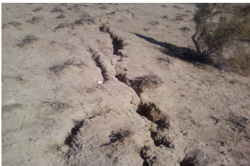
شکل ۴-۵: گسیختگی زمین در محدوده‌ی بین چاه‌های ۱۰ و ۳۱
