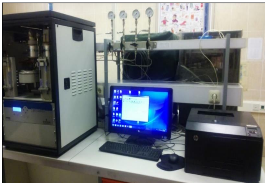
شکل ۳-۲- دستگاه آنالیز پیرولیز راک-اول (آزمایشگاه پیرولیز راک اول، واحد ژئوشیمی، پژوهشگاه صنعت نفت تهران، ۱۳۹۶)
