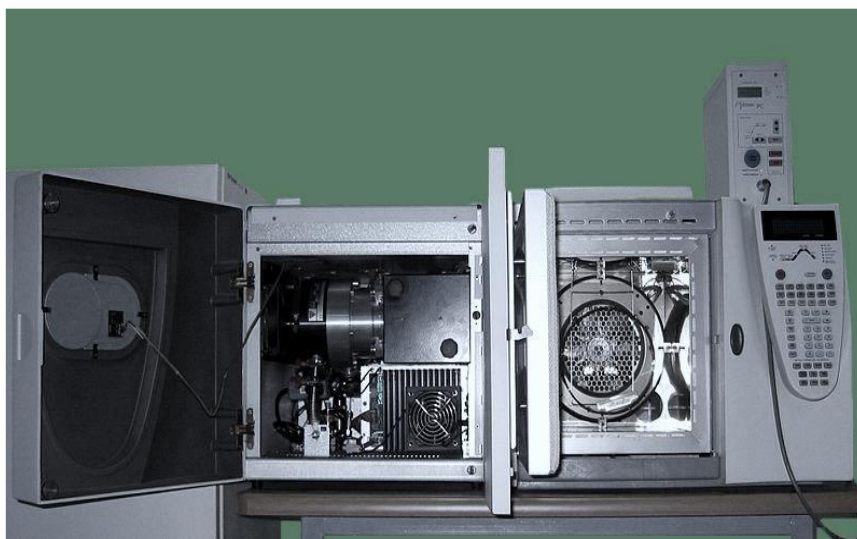
شکل ۳-۴- دستگاه کروماتوگرافی گازی-جرمی، (آزمایشگاهی ری نورآزما، ۱۳۹۶)
