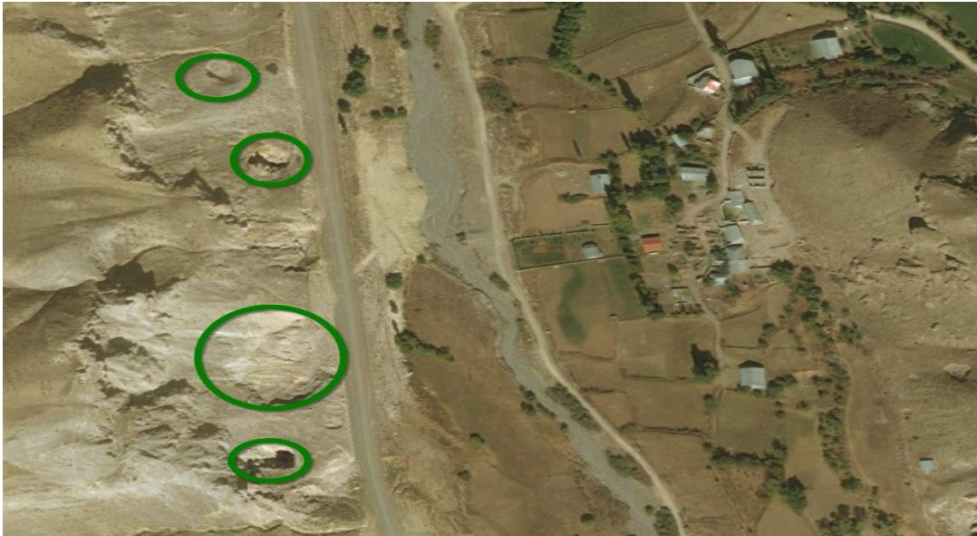
شکل ۱-۱۲- تصویر هوایی فروچاله‌های موجود در سازندهای گچی (روستای حطر)
